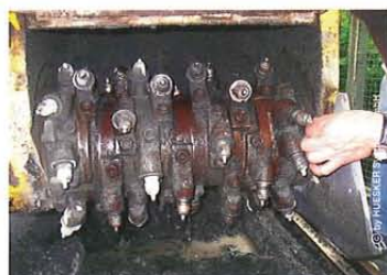
Bild 5: Nahezu keine Fasern haben sich um die Fräsvalze gelegt
