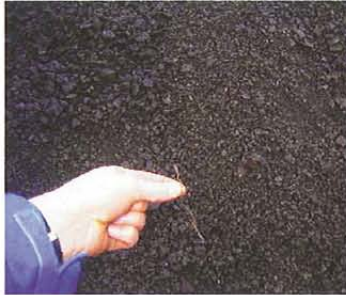
Bild 7: Nur kurze Restfasern des Gitters sind im Fräsgut zu erkennen
